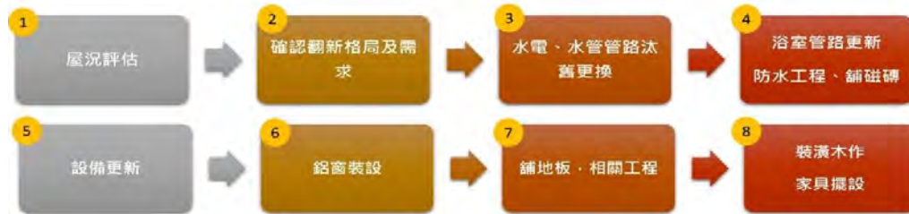
圖 1. 老屋翻新基本流程圖 (圖片來源：高雄 EHO 室內設計網站)
