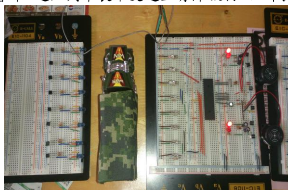
圖 13 偵測有障礙物而啟動平交道緊急 LED 警示燈與 MD 警示鈴
