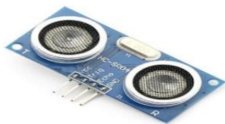
圖5 超音波感測組件HC-SR04及對應至樹莓派GPIO接腳
